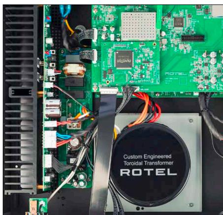
Ein großzügiger Ringkerntrafo aus eigener Fertigung sorgt für satten Energienachschub.
