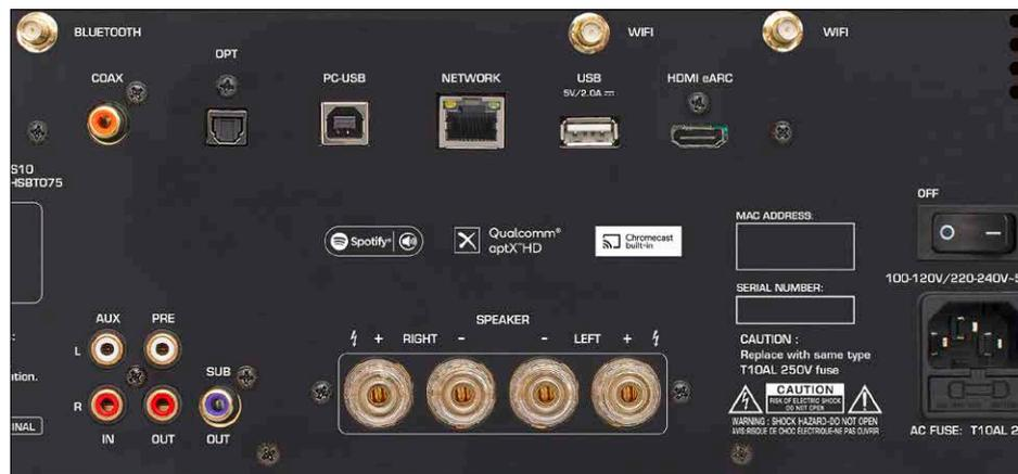
Der Rotel weist neben nur einem Analogeingang vor allem digitale Anschlussmöglichkeiten auf, darunter auch HDMI, BT, LAN, USB-A/B, DAC, Pre- und Sub-out werden allerdings ebenfalls geboten.
