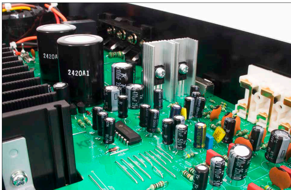
Auch im Vorverstärkerteil sind kurze und verlustarme Signalwege mit wenigen, aber dennoch guten Bauteilen wichtig. Nur so lassen sich Klang und Preis vereinbaren.
