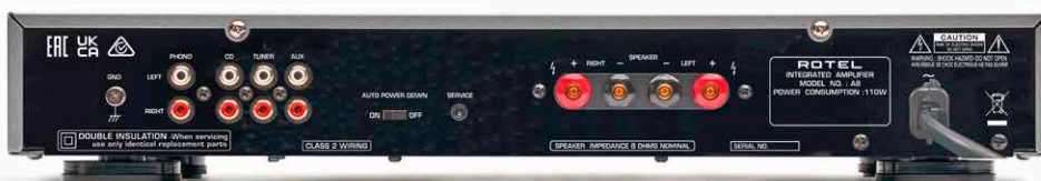
Phono MM, drei Cinch-Hochpegelquellen und ein Boxenpaar finden bequem Anschluss am kleinen Rotel A8. Mittig am Heck gibt es eine Servicebuchse und den abschaltbaren Auto-Shutoff.
