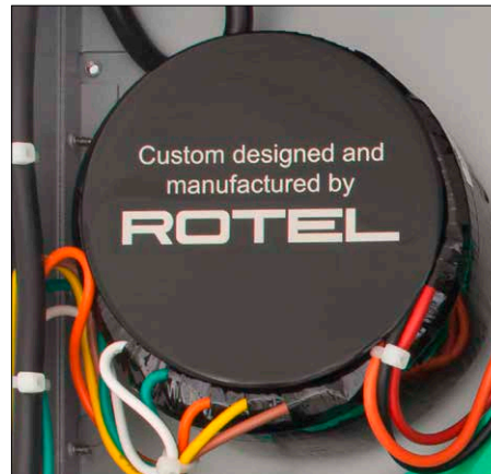
Im Rotel A8 übernimmt ein hochwertiger Ringkerntransformator die Energieversorgung.
